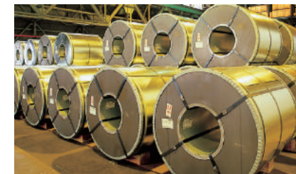
溶融亜鉛メッキコイル(Tジंक、Tアロイ)
