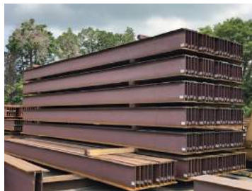
宇都宮工場生産されるTH (特寸H形鋼・Tuned-H)
